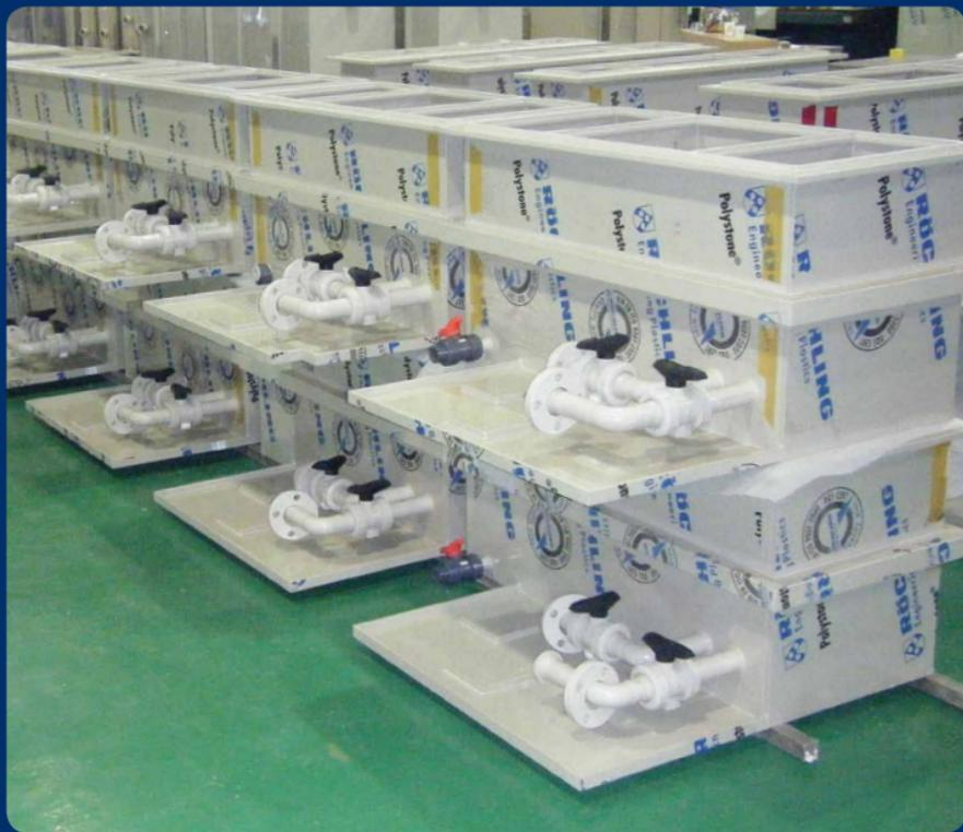
Eine Kupferbeschichtungsanlage in Südkorea – vollständig aus chemikalienbeständigem Kunststoff hergestellt. Weltweit sind Hochleistungs-Kunststoffe von Röchling, Haren, in nahezu allen Investitionsgüterindustrien im Einsatz.
