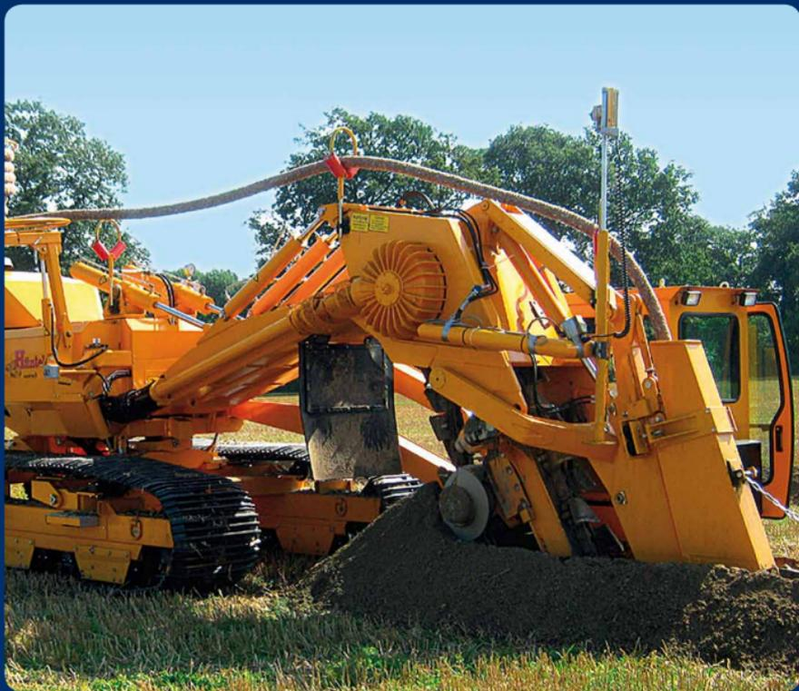
Leistungsstarke Maschinen von Hüntelmann aus Werpeloh werden weltweit für Dränmaßnahmen, die Grundwasserabsenkung oder die Kabel- und Rohrverlegung eingesetzt.
